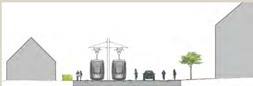
Køreledninger på master placeret langs med sporets linjeføring imellem sporene
